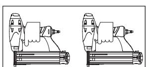
**ADVERTENCIA** Una herramienta que funciona de manera inadecuada no debe usarse. No active la herramienta a menos que esté colocada firmemente contra la pieza de trabajo.
