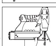
dégager le bouton pour réengager le crochet avec la buse.
