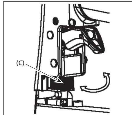
3. Pour enfoncer une attache plus profondément, tourner la roue (C) vers la gauche jusqu'à la profondeur recherchée.
