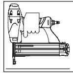
**FONCTIONNER.** Si l'éjection d'une attache se produit lorsqu'on relève l'outil, ne pas utiliser celle-ci. Il y a risque de blessures.
