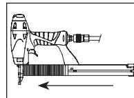
5. Toujours retirer toutes les attaches du chargeur avant de ranger l'outil. Le déchargement est l'inverse du chargement, sauf qu'on doit **débrancher** l'approvisionnement d'air avant de décharger.
