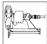
Appuyer le mécanisme de déclenchement par contact (WCE) sur la surface de travail. Actionner la gâchette. Enlever tout excès d'huile sortant par le déflecteur d'échappement.
