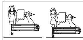
La gâchette doit être relâchée afin de rajuster l'outil avant d'enfoncer un autre attache.
