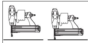
Appuyer le mécanisme de déclenchement par contact (WCE) sur la surface de travail. L'outil **NE DOIT PAS**
