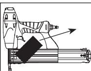
**AVERTISSEMENT** *Ne pas retirer toutes les attaches mènera à une éjection des attaches par l'avant de l'outil.*
