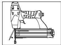
5. Retire todos los sujetadores que estén trabados, utilizando unas pinzas o un destornillador si fuera necesario.
